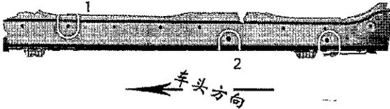
I 拆下原车边梁，在原车侧边梁处露出一排卡子孔和两个圆孔。
